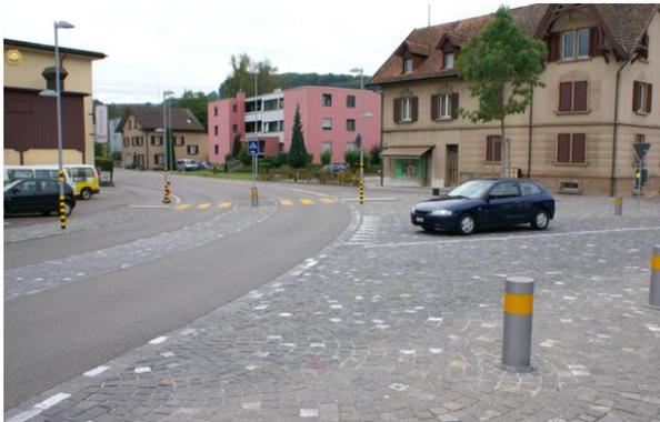
Abbildung 14: Beispielfoto: Durchgängiger Platz bei Einmündung und Mehrzweckstreifen im Knotenbereich
