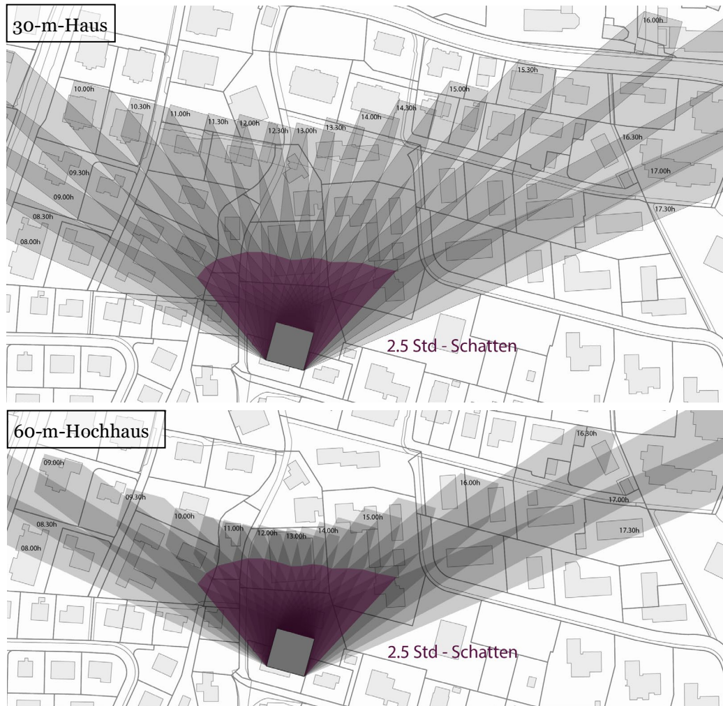
Abbildung 23: 2.5-Stundenschatten 30-m- bzw. 60-m-Haus, Metron AG, Kartengrundlage: Amtliche Vermessung
