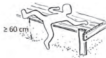
Plattform, die mindestens 60 cm über dem Boden liegt
