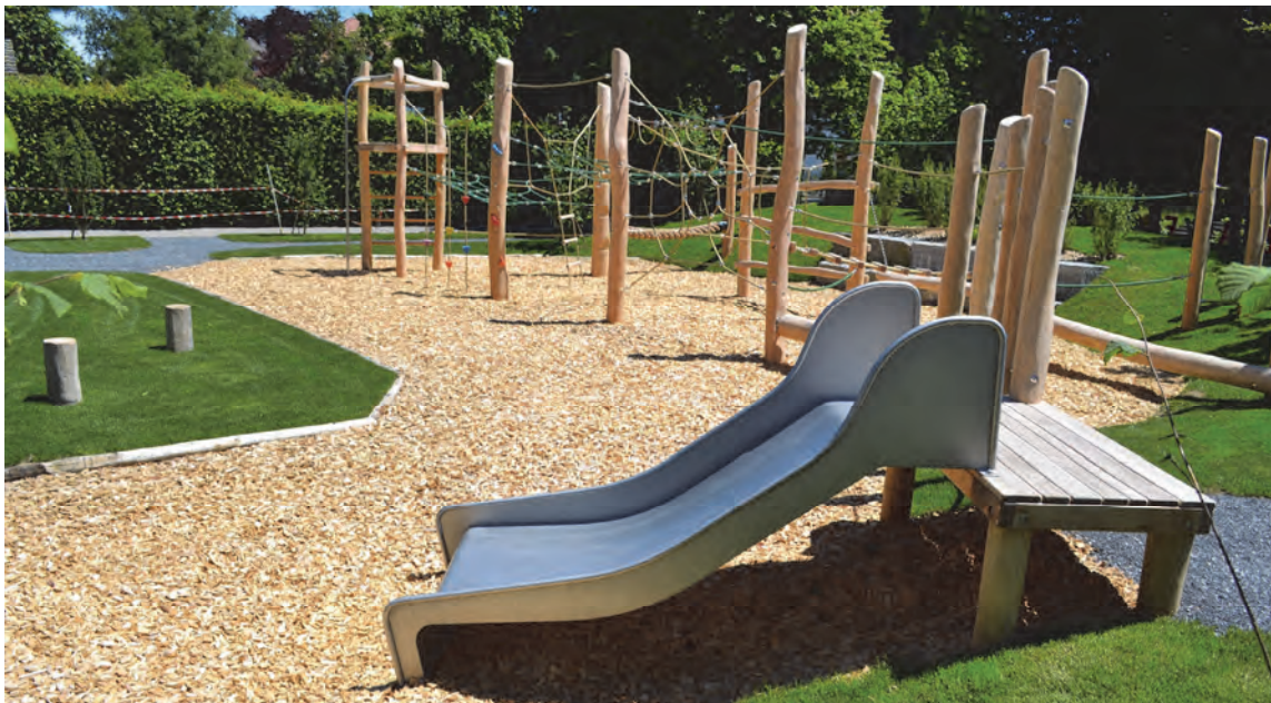
Abbildung 2 Spielplatzgeräte mit niedrigen freien Fallhöhen
